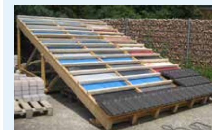
Abb. 38 a/b: Testdach zur Untersuchung der Alterungsbeständigkeit von Unterdeckbahnen im eingedeckten Nutzungszustand
