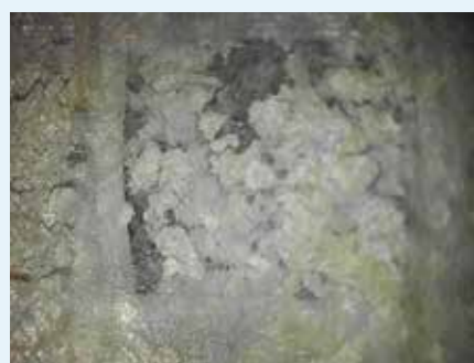
Abb. 36 a/b: Mikroskop-Aufnahmen von Unterdeckbahnen nach 13 Wochen Freibewitterung zeigen Rissbildung und massive Auflösungserscheinungen
