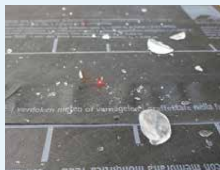
Abb. 34: SOLITEX-Unterdeckbahnen auf Holzfaserdämmplatte bleiben auch bei mehrmaligem Beschuss mit 50 mm Hagelkorn unbeschädigt
