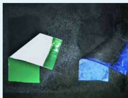
Abb. 41: Wasserfestigkeit von Klebebändern. Links: Klebeband mit wasserlöslicher Acrylat-Emulsion »verseift« und verflüssigt unter Wassereinfluss. Rechts: Klebeband mit wasserfestem SOLID-Kleber, Trennung der Verklebung nur zerstörerisch möglich
