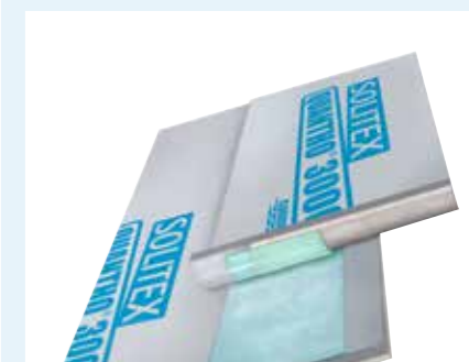
Abb. 43: Selbstklebezone mit Dichtlippe – TPU-Beschichtung und Kleber ragen über das Trägervlies hinaus, wodurch die beiden Funktionsschichten direkt verbunden werden.
