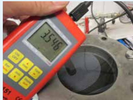
Abb. 24 a/b: Hydrostatischer Druckversuch im Labor – mittel Überdruck durch Pressluft wird eine künstliche Wassersäule simuliert. Gute Unterdeckbahnen erreichen Werte von über 2.500 mm.
