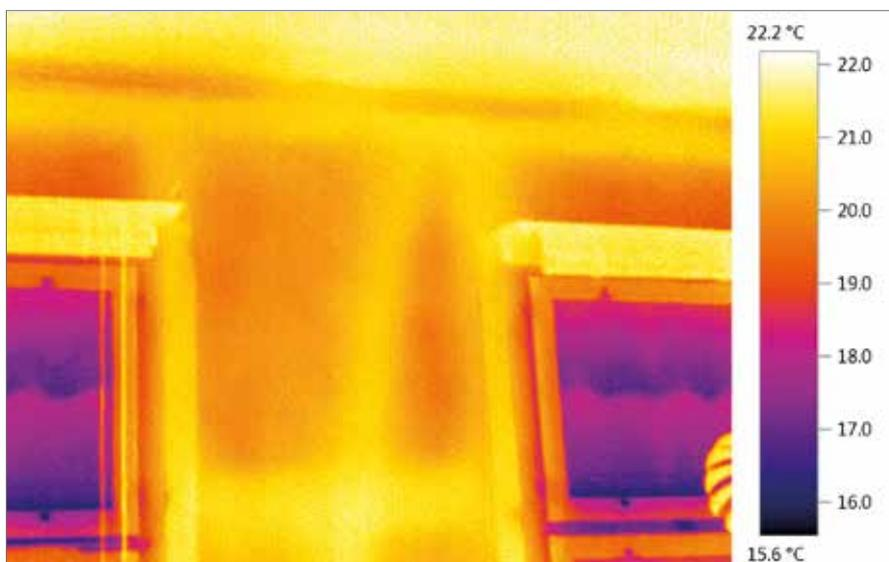
*Thermographie du mur extérieur : thermographie d'un mur à ossature avant l'assainissement*
