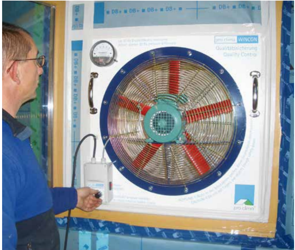
El ventilador de ensayo WINCON se coloca en una ventana o en una puerta. La depresión que ocasiona en la casa ayuda a encontrar desperfectos o fugas.
